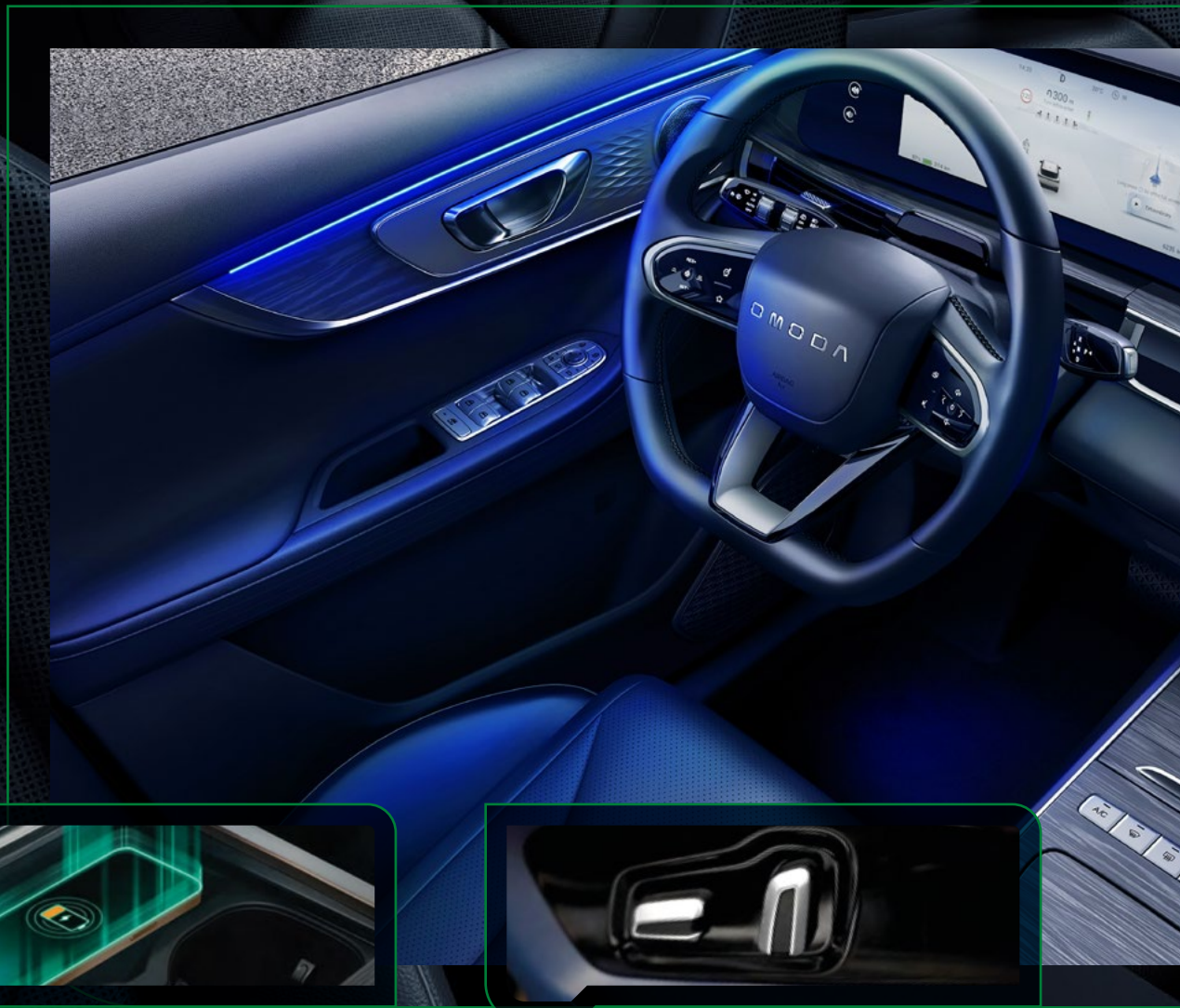
Ładowarka indukcyjna o mocy 50W
